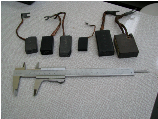
Rys. 10. Elementy układu pomiarowego. Objasnienia: a) szczotki i suwmiarka, b) ława pomiarowa.
